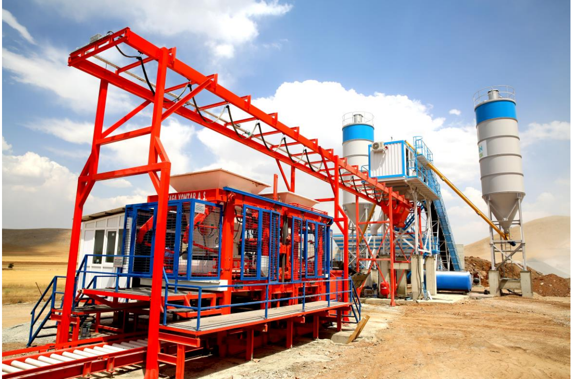
-Afşin'e Kazandırdığımız Beton Elemanları Üretim Tesisi-
